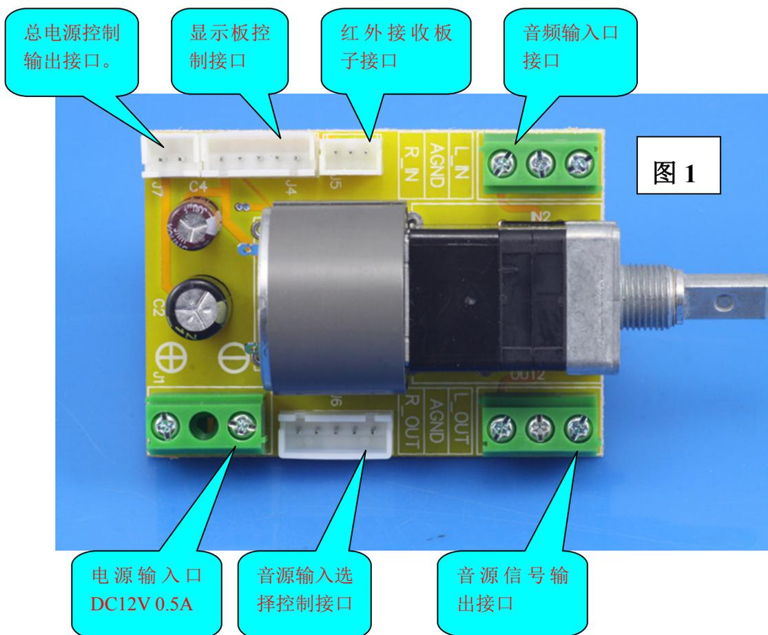
**注释：**图 1 注明了各接口的功能。图 2 中有 2 组特殊功能的焊盘。其中 T2 是引出作为按键功能使用。T1 的功能下面使用流程说明中再做说明。
