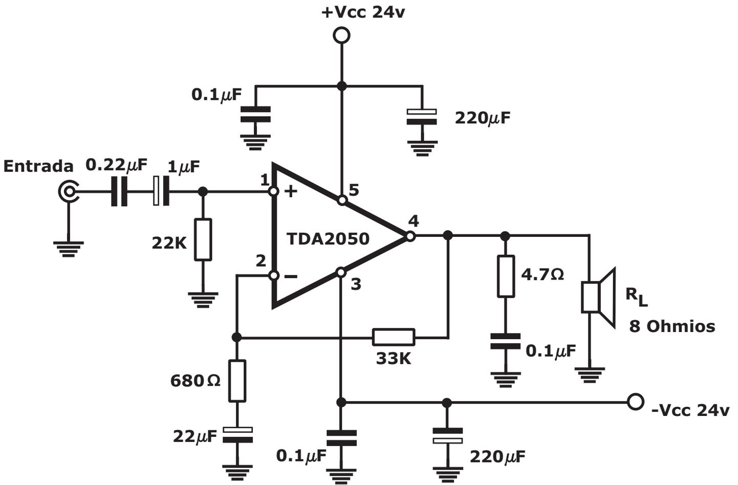
El TDA 2050 tiene un circuito que limita la corriente de los transistores de salida. La máxima corriente de salida es una tensión entre colector y emisor, por lo que los transistores de salida, trabajan dentro de su área de operación seguras. Esta función en lugar de ser una simple limitación de corriente, reduce la posibilidad de que el integrado se dañe durante un cortocircuito accidental de AC salida a tierra.
