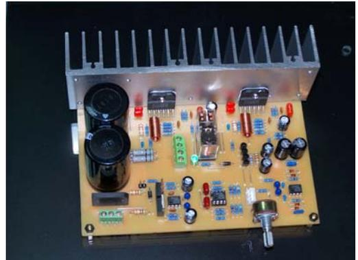
LM3886TF 是美國 NS 公司推出的大功率音頻放大 IC，其後面的 TF 爲全絕緣封裝，也就是安裝散器時不必再加雲母片來絕緣，在額定工作電壓下最大可達 68W 的連續不失真平均功率，具有比較完善的過電壓、過電流、過熱保護的功能，最可貴的是它具有自動抗開關機時的電流沖擊的功能，使喇叭能夠安全的工作。LM3886 優異的性能，使得它在近幾年音響製作中廣泛的應用，許多成品功放機中就有直接的應用它擔任後級功放或者用它作爲重低音放大電路。其特點有：輸出功率大（連續輸出功率 68W）、失真度小（總失真加噪聲 < 0.03%）、保護功能（包括過電壓保護、過熱保護、電流限制、溫度限制、開關電源時的揚聲器衝擊保護、靜音功能）齊全，附加零件少，製作調試容易，工作穩定可靠。由於用它製作功率放大電路具有簡易、適用的特點，特別適合發燒友以及電子愛好者的製作。
